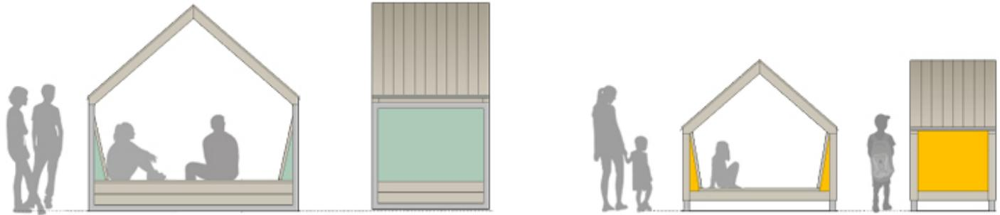
Die Konstruktion aus Stahl und Holz ist modular aufgebaut und kann je nach Einsatzort mobil aufgestellt oder dauerhaft auf Fundamente montiert werden.
